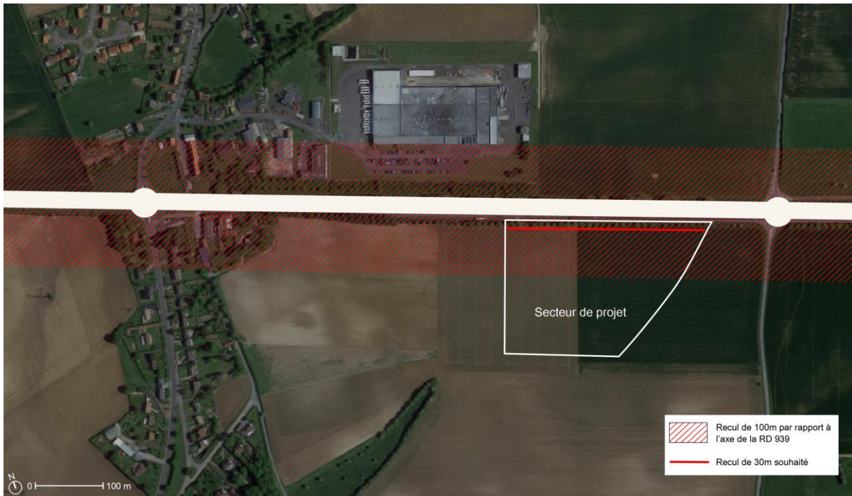
Figure 38 : Limites de recul de 25m et 100m par rapport à l'axe de la RD 939 – Source AnteaGroup
